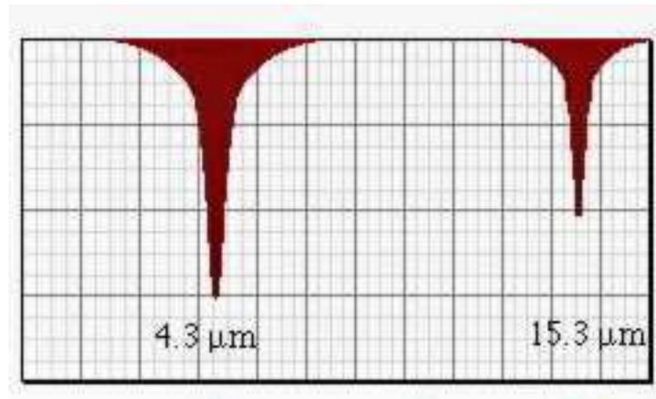
Abb. 4: Absorptionsspektrum von Kohlendioxid. Bei  $4,3 \mu\text{m}$  Schwingungen der CO-Bindungen. Bei  $15,3 \mu\text{m}$  Biegeschwingung. Aus: [www.chemie-im-alltag.de/articles/0024/index2.html](http://www.chemie-im-alltag.de/articles/0024/index2.html)
